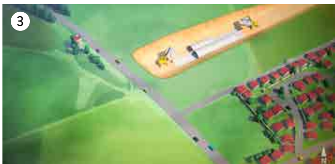
Pose des éléments préfabriqués de la section couverte
