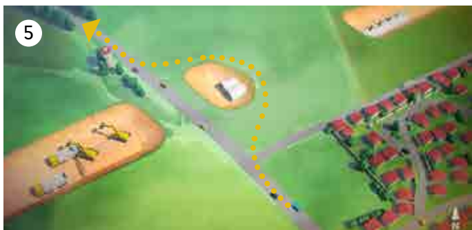
Préparation de la déviation de la RD 226 et terrassement de la partie Ouest
